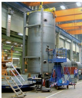
Расположение тела котла в оптимальной позиции для сварки
